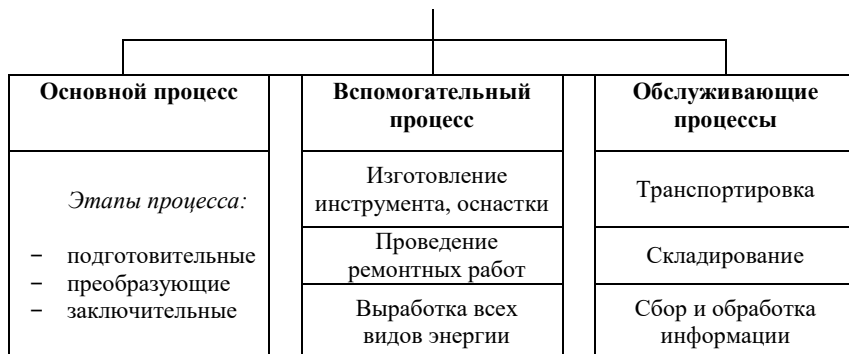
Рис. 1. Структура производственного процесса на предприятии
